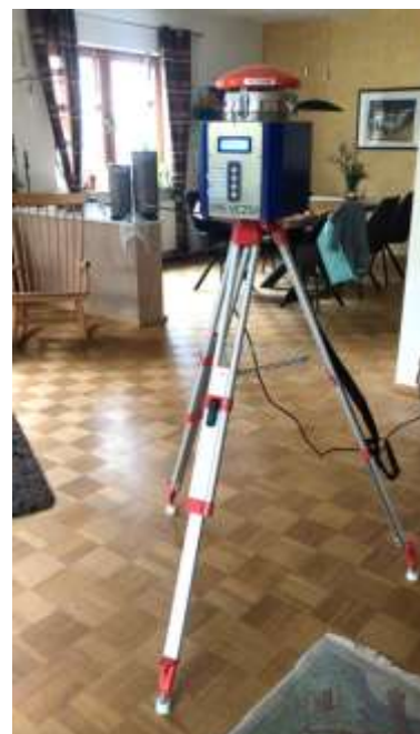
Abbildung 7: Probenahme des luftgetragenen Feinstaubes mit dem VC 25 II
